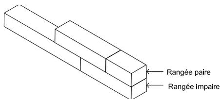
\* Il est possible d'alterner les blocs (A, B ou C) dans une même rangée pour créer différents motifs. Cependant, un espacement minimal de 1/4 de la longueur du bloc, entre les joints verticaux, est requis.
